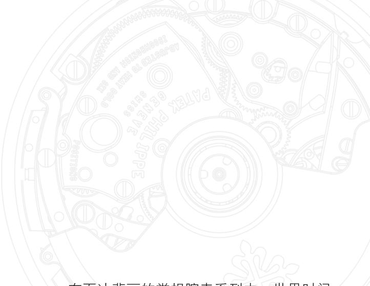
在百达翡丽的常规腕表系列中，世界时间计时腕表可谓是引领先河的计时杰作，将两项标志性的复杂功能集于一身。迄今为止，有一枚腕表集合了这两项复杂功能，即1940年制作完成，编号为862,442的经典时计。此次推出的新款世界时间计时腕表不仅传承经典，更融汇了21世纪的创新精神。在研发新款机械机芯CH 28-520 HU的过程中，百达翡丽制表师依托配备垂直离合器和星柱轮的CH 28-520自动上弦计时机芯，巧妙结合了百达翡丽著名的世界时间专利装置。此装置只有一个时区调校按钮，使用极为便利。由于垂直离合器的摩擦几乎可以忽略不计，计时秒针（也称直驱指针）还可用作连续秒针。此款机芯遵照百达翡丽印记的严格标准精心打造，同时融合了诸多创新，包括可提高等时性的专利——Spiromax®摆轮游丝。
