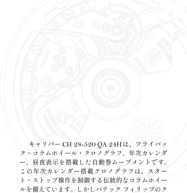
キャリバー CH 28-520 QA 24Hは、フライバック・コラムホイール・クロノグラフ、年次カレンダー、昼夜表示を搭載した自動巻ムーブメントです。この年次カレンダー搭載クロノグラフは、スタート・ストップ操作を制御する伝統的なコラムホイールを備えています。しかしパテック フィリップのクラシックなコラムホイール・クロノグラフと一線を画する、卓越した技術革新により特徴づけられます。すなわちクランプがレバーに取り付けられたクロノグラフ輪列のクラッチ車を制御する水平クラッチ式ではなく、2つのクランプがクラッチ・ディスクを制御し、4番車からの動力をクロノグラフへ伝達する（クロノグラフ作動時）、もしくは伝達しない（クロノグラフ非作動時）という切り替え方法（垂直クラッチ式）が取られています。このきわめて信頼性の高い解決法により、時計の計時精度を損なうことなく、クロノグラフ秒針を常時回転させてセンター セコンドのように用いることができます。その結果、パテック フィリップの年次カレンダー搭載クロノグラフは、これまでの多くのクロノグラフに見られたスマートセコンドを必要としません。
