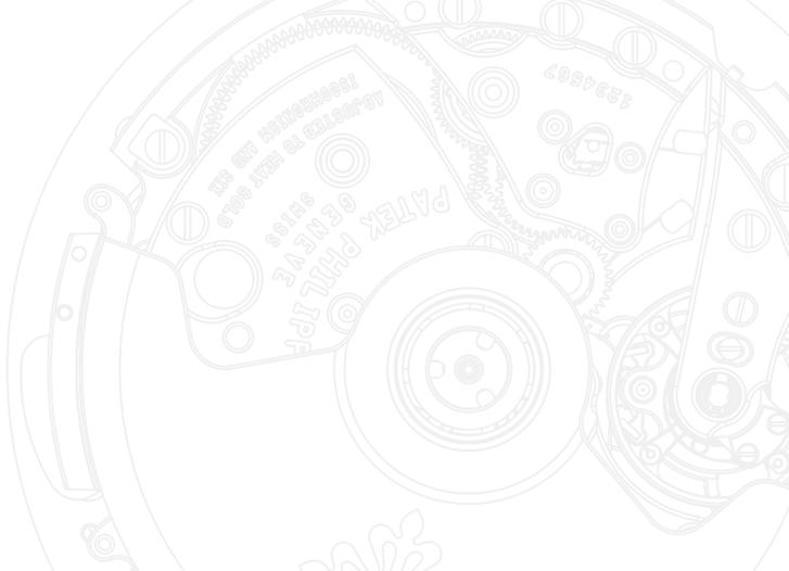
キャリバー CH 28-520 IRM QA 24Hは、フライバック・コラムホイール・クロノグラフ、年次カレンダー、昼夜表示を搭載した自動巻ムーブメントです。この年次カレンダー搭載クロノグラフは、スタート・ストップ操作を制御する伝統的なコラムホイールを備えています。しかしパテックフィリップのクラシックなコラムホイール・クロノグラフと一線を画する、卓越した技術革新により特徴づけられます。すなわちクランプがレバーに取り付けられたクロノグラフ輪列のクラッチ車を制御する水平クラッチ式ではなく、2つのクランプがクラッチ・ディスクを制御し、4番車からの動力をクロノグラフへ伝達する（クロノグラフ作動時）、もしくは伝達しない（クロノグラフ非作動時）という切り替え方法（垂直クラッチ式）が取られています。このきわめて信頼性の高い解決法により、時計の計時精度を損なうことなく、クロノグラフ秒針を常時回転させてセンターセコンドのように用いることができます。その結果、パテックフィリップの年次カレンダー搭載クロノグラフは、これまでの多くのクロノグラフに見られたスモールセコンドを必要としません。
