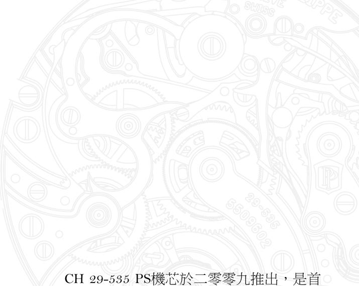
CH 29-535 PS機芯於二零零九推出，是首枚由百達翡麗製錶工作坊獨自全面研發並生產的經典計時秒機芯。機芯在傳統架構（導柱輪、橫向離合器及人手上弦）上結合六項專利革新設計，包括專利的輪齒形狀，增強離合器和計時秒齒輪之間的滲透調整，以及自動置中的重設敲錘。機芯更具備數項改善功能和表現的技術特點，例如30分鐘瞬跳計算器；種種革新體現傳統計時秒機芯的超現代改良舉措。大型Gyromax®擺輪配備四條輪幅及四枚砝碼，以高達4赫（每小時半擺動28,800次）的頻率擺動，保證操作穩定。機芯動力儲備為65小時（處於計時秒功能模式時為50小時）。透過寶石玻璃錶殼底蓋，可欣賞到機芯精緻的美學及精工細節（經典S型離合器槓杆和傳統夾板橋，以及精心製作的削角邊緣和日內瓦條紋裝飾）。錶面清晰可讀，並在3時略低於錶面中軸線位置設有30分鐘計算器，正對9時位置則設有小三針附屬顯示盤。全錶融合卓越技術、精緻美學和手工技藝，叫人讚嘆。
