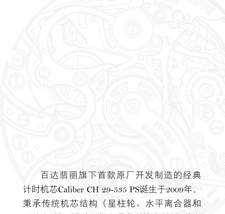
百达翡丽旗下首款原厂开发制造的经典计时机芯Caliber CH 29-535 PS诞生于2009年，秉承传统机芯结构（星柱轮、水平离合器和手动上弦），同时汇集六项专利技术创新，其中包括优化轮齿外形，改善离合制动轮与计时轮之间的啮合深度调节以及自动定心重置锤。这款机芯还具备多项工艺特征，增强了计时机芯的功能特点以及计时性能，例如30分钟瞬跳累积计时器。现代风格演绎传统计时机芯。四臂四重Gyromax®摆轮的振动频率增至4赫兹（每小时28,800次半摆），确保出众的运行稳定性。机芯拥有65小时动力储存（若处于计时模式，则为50小时）。透过蓝宝石水晶底盖，可以欣赏到机芯的精妙风格与考究细节（配备经典的S形离合推进杆和传统夹板，采用工艺精湛的斜角处理，雕饰日内瓦条纹）。表盘清晰易读，3时位置设有30分钟计时盘，位置略低于中心轴，处于9时位置小秒针的正对面，别具一格。融合先进技术、精致美学与精湛工艺，成就动人杰作。
