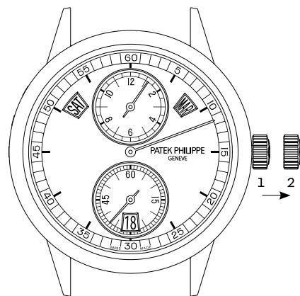
Su reloj tiene un sistema de “stop/segundo” que le permite realizar la puesta en hora al segundo exacto, basándose en una señal acústica. Cuando usted extrae la corona (posición 2), la aguja de los segundos se para instantáneamente. Se pone de nuevo en marcha de inmediato cuando usted vuelve a presionar la corona contra la caja (posición 1).
