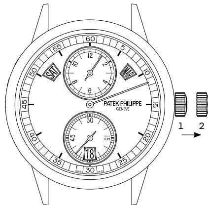
您的腕表配有停秒装置，只要您将表冠拉出到位置2，秒针将立刻停止走动。这样您就可以在声音信号的提醒下，将腕表走时同步到秒钟。一旦表冠归位（位置1），秒针就会立即开始转动。
