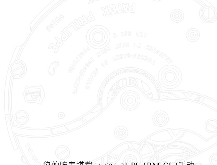
您的腕表搭载31-505 8J PS IRM CI J手动上弦机芯，配备星期和日期瞬跳显示功能，具有长达八日动力储存，需要格外细致的能耗管理。这款机芯历经五年研发而成，秉承传统结构，同时融入多项创新技术与优化功能，尤其是以Silinvar®材质擒纵轮和擒纵叉组成的Pulsomax®擒纵装置，此为百达翡丽“先进技术研究”项目的一项重要成果。两个串联发条盒确保腕表精确运转长达八日，动力储存消耗至第九日时，设于12时位置的动力储存显示将以红色标示，提醒表主为机芯上弦。每晚午夜，位于6时位置辅助表盘的星期和日期显示会瞬间跳转，与辅助表盘上的小秒针相辅相成。
