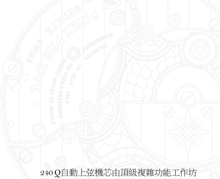
240 Q自動上弦機芯由頂級複雜功能工作坊（Grand Complication workshops）獨自全面製作，並刻上著名的百達翡麗印記。機芯由275枚部件組成，體積超薄，厚度僅3.88毫米。這有賴機芯內添置22K金側置迷你擺動陀，配合萬年曆及月相裝置的巧妙安排，得以發揮如此極致的表現。萬年曆裝置配備48個月（4年）凸輪，能夠自動顯示正確日期，並顧及每月31日、30日或28日，以及閏年2月29日的日數變化。萬年曆裝置在2100年之前無須校正；上述世紀年為特殊例子，根據格雷果里曆法，年內並無2月29日。所有年曆顯示資料僅需使用嵌於錶側的四個按鈕調校，簡單方便。
