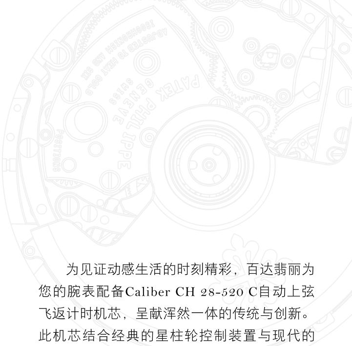
为见证动感生活的时刻精彩，百达翡丽为您的腕表配备Caliber CH 28-520 C自动上弦飞返计时机芯，呈献浑然一体的传统与创新。此机芯结合经典的星柱轮控制装置与现代的垂直离合器，可以防止指针在计时功能启动时发生跳动或反弹。同时，该离合器几乎不会造成摩擦，所以中心计时秒针亦可用作连续转动的中心秒针，这样就无需使用小秒针表盘。腕表佩戴者可以使用飞返功能来启动按钮，在计时指针转动时直接开始新的计时，无需重置。借助停秒功能，将计时秒针瞬间转变为连续秒针，方便腕表同步时间。表盘下部配备尺寸较大的同轴计时器，确保时间显示清晰可辨，可计量60分钟和12小时的时间。此外，3时位置还设有日期视窗，只需数分之一秒即可完成显示变更。
