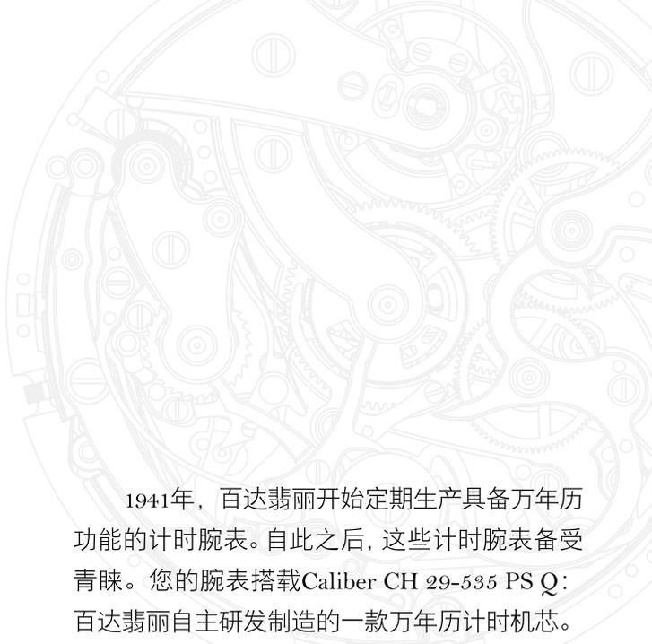
1941年，百达翡丽开始定期生产具备万年历功能的计时腕表。自此之后，这些计时腕表备受青睐。您的腕表搭载Caliber CH 29-535 PS Q：百达翡丽自主研发制造的一款万年历计时机芯。这款机芯秉承传统机芯结构（星柱轮、水平离合器和手动上弦），同时汇集了六项专利技术创新。增加万年历功能需要研发采用超薄设计的全新日历装置（182个部件，厚度1.65毫米）。透过蓝宝石水晶底盖，可以欣赏到机芯结构与精巧细节。表盘采用百达翡丽传统万年历计时腕表布局：12时位置的并排双视窗分别显示星期和月份，6时位置的指针式日期显示与月相显示视窗合二为一。这款腕表具备多项标志性功能，包括两个小型圆孔视窗分别显示昼/夜和闰年，以及位置略低于中心轴的秒针小表盘和30分钟累积计时盘。尽管表盘拥有11项显示功能，但整体布局合理，清晰易读。
