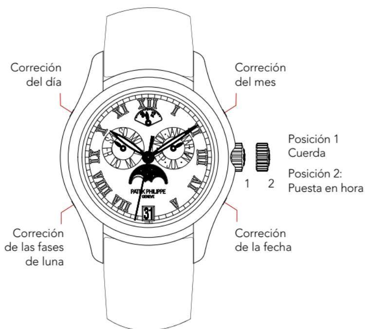
*Esquema válido para todos los relojes dotados del calibre 324 S QA LU o 324 S IRM QA LU.*
