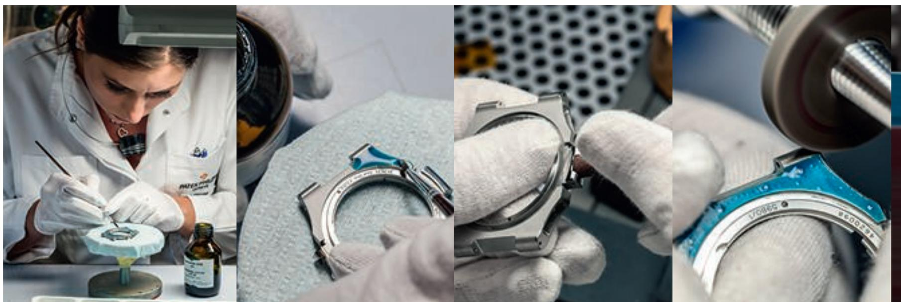
der Einsatz der Klebefolie. So muss der geschlitzte Streifen zum Abdecken der satiniierten „äußeren“ Glieder ganz exakt aufgeklebt sein, um die inneren Glieder zu schleifen und dann mit einer Baumwollscheibe zu polieren, ohne den Schliff der äußeren Glieder zu beeinträchtigen.
