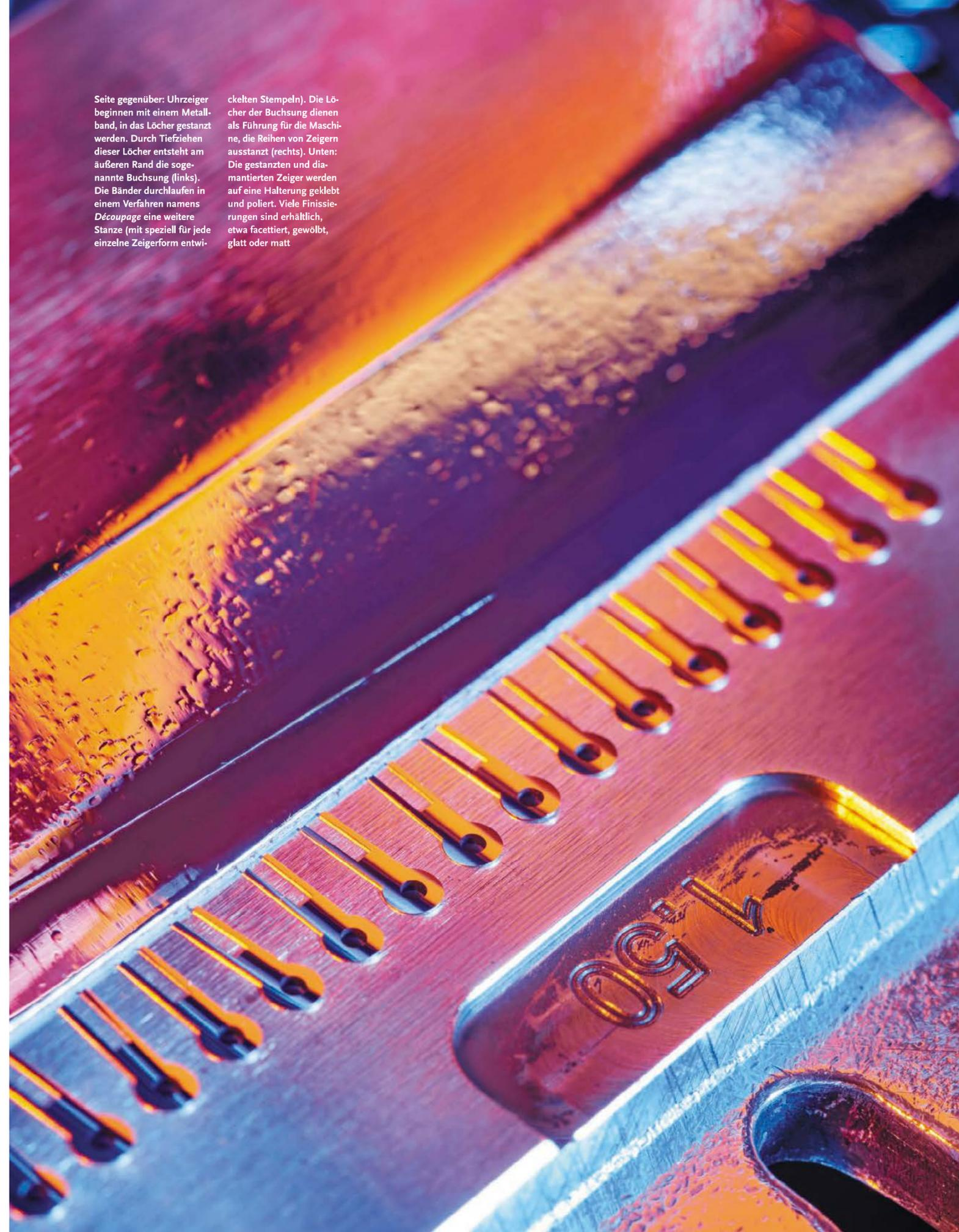
Diese Seite: Das gewölbte Profil bestimmter Zeiger formt ein Schlagwerkzeug in einem als *Frappe* bekannten Verfahren. Gegenüber: Eine Superluminova®-Lösung wird auf Zeiger aufgebracht, die im Dunkeln leuchten sollen (rechts), die Lackierung erfolgt von Hand (links)
