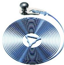
Spiromax<sup>®</sup> 髭ゼンマイは、卓越したSilinvar<sup>®</sup>の物理学的特性と、特許を取得したパテック フィリップ独自の幾何学形状（パテック フィリップ・エンドカーブ、自動的に精密にセンタリングが行われる髭玉、髭ゼンマイと一体化した髭持ち）により、アイソクロニズム（等時性）の向上に決定的な貢献している。完璧な同心円性を保持しながら収縮・伸長する。また完璧な耐磁性、腐蝕耐性、衝撃耐性を持ち、温度変化に影響されない。また完全な平面状をなしているため、同一のアイソクロニズム（等時性）を持つフィリップス・エンドカーブ付のブレゲ髭ゼンマイに比べ1/3の厚さであるため、超薄型ムーブメントの製作が可能となる。これほど理想的な特長を合わせ持つ髭ゼンマイはこれまで存在したことがなかった。
